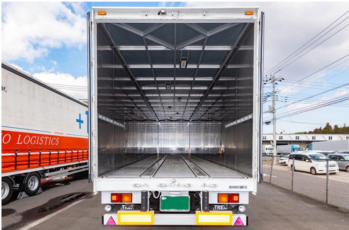
ULD96インチパレットは全幅約244cmあるが、日本の法規では大型車の全幅は2.5m以下と規定されている。そのため、「+1」セミトレーラー側壁の厚みはわずか2cmほどしかない。トラックに積み込む倉庫のプラットホームにバックでつける時、パレットがスムーズに荷室内に入るようにするには、寸分の狂いなく指定の場所に停車しないとならないという。数センチずれただけでも、パレットが車体の壁に当たってしまうのだ。
