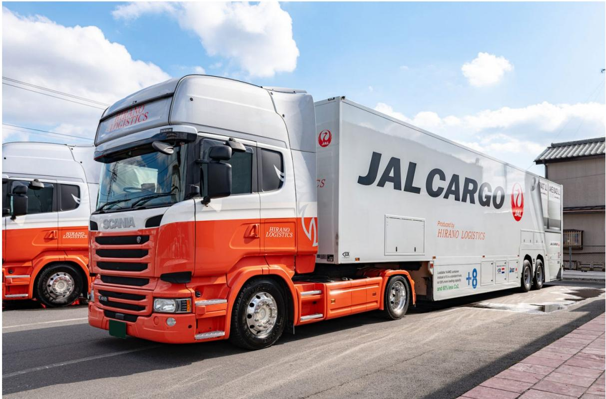
レーシングカーのトランスポーターのように精悍な印象を持つ「+8」。LD3コンテナを従来の大型トラックよりも8台多く積めることから命名された。エアサスペンションを装備。
