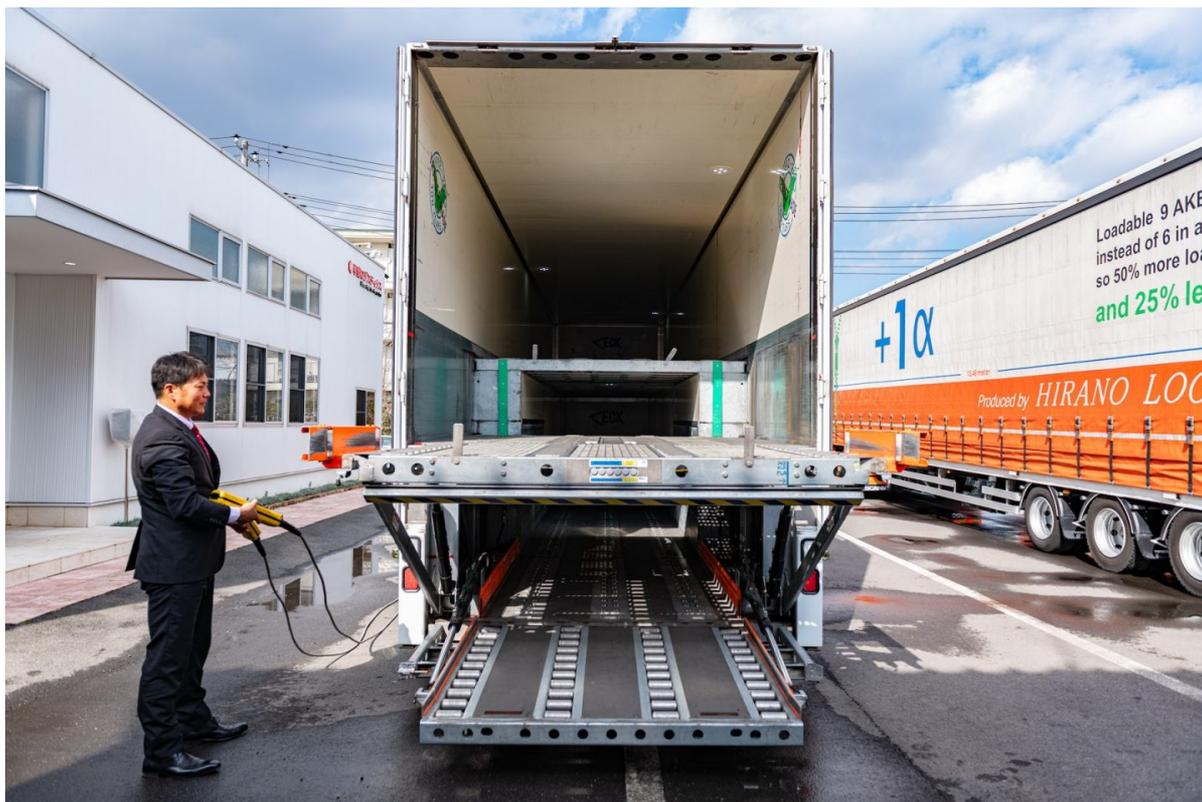
トレーラー内は2段式になっており、LD3コンテナを14台、もしくは96インチパレット4枚+LD3コンテナ6台を積載できる。パレットやコンテナを積むためのエレベーターは油圧作動で、リモコンで操作できる。
