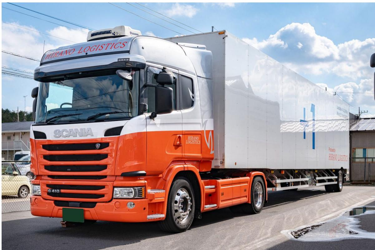
こちらが、スカニアがULD96インチパレットの「+1輸送」を実現したセミトレーラー。96インチパレットを4枚積載可能である。スカニアにラインナップしていた小径タイヤのトラクターが、カブラー高98cmだったことから、低床でフラットな荷室を作ることができた。搭載可能範囲は幅244×長さ1280×高さ250cm、全長16.4m。エアサスペンションを持つ。なおULDとはunit load deviceの略。
