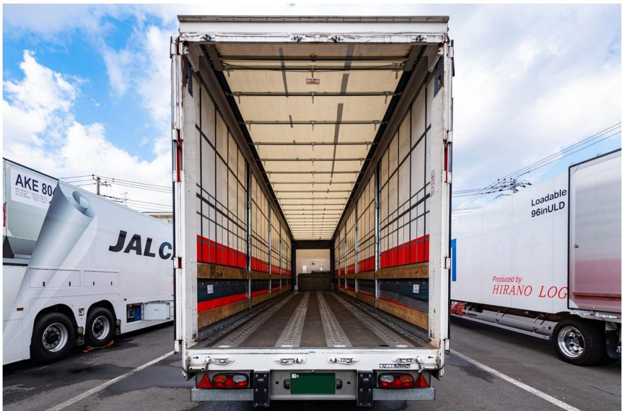
搭載可能範囲は幅244×長さ1465×高さ268.5～300cm。床面にはエアで出し入れするローラー（滑車）を備えており、ローラーを上げれば、人力でも重さのあるパレットを移動することができる。
