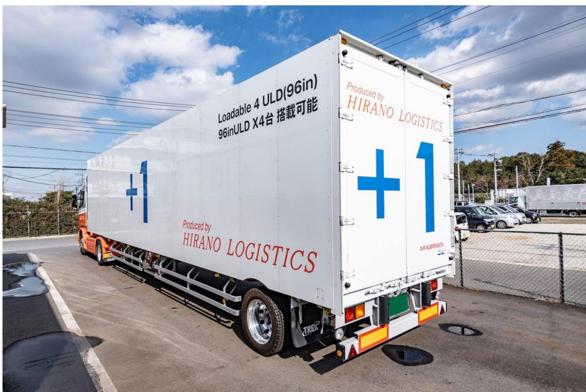
航空貨物では極端に重いものを運ぶことがないため、この車両も最大積載量は10tと設定されており、全長16m40cmに達するセミトレーラーでは珍しい1軸でも対応できる。平野ロジスティクスでは、「+1」セミトレーラーを17台保有する。
