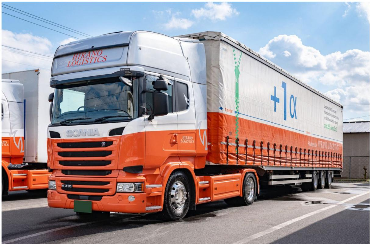
こちらは20台が活躍する、「+1α」セミトレーラー。オランダのVanEck（ヴァンエック）製で、背が高い貨物を載せたパレットを4枚積むことが可能。全長は17.8m。こちらにもエアサスペンションを備え、貨物への衝撃を少なくする。トレーラーの側壁と屋根を布にしたことで、側面からのパレット取り出しおよび高さの変更が可能になっている。日本ではバンタイプのトレーラーで構体部を布製とした車両は珍しいが、欧州では一般的だ。
